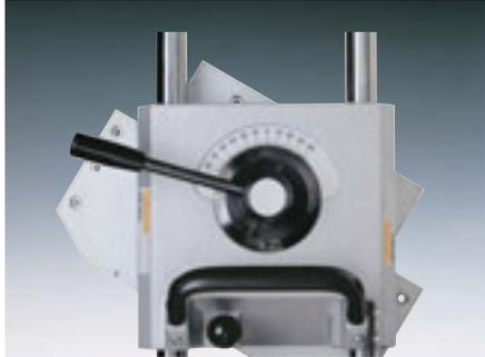
**Прорезание пазов под углом к краю балки.**
