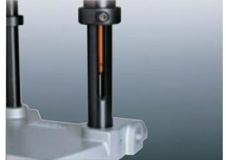
**Подъёмное устройство с газонаполненным амортизатором.**
