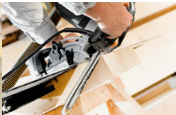
Точный пропил с соблюдением углов на глубину до 200 мм. Как в древесине, так и в твёрдых изоляционных материалах. Чистейшие косые пропилы до  $60^\circ$ .
