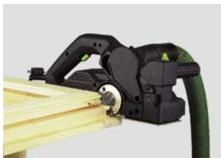
Выборка четвертей без ограничения по глубине благодаря консольному креплению головки рубанка.
