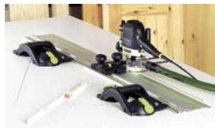
Так и при фрезеровании пазов в заготовках с гладкой поверхностью двойной вакуумный держатель все упрощает: установите адаптер, прижмите присоски и фрезеруйте.
