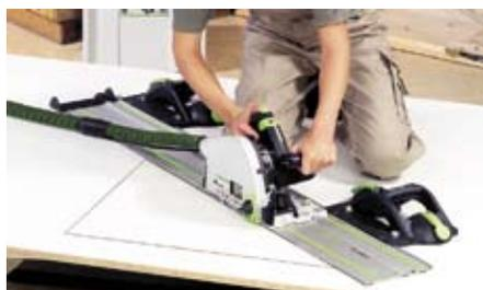
Надежная и чистая фиксация. Просто установите адаптер на шину-направляющую, присоедините GECKO, затяните винты и прижмите – готово.
