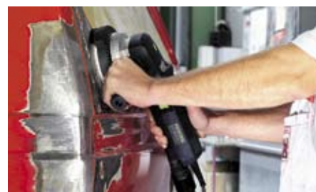
RAS 115 идеально подходит для удаления лаков и красок. И не в последнюю очередь благодаря MMC электронике и антистатическому оснащению.
