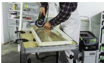
RAS 115: мощный и легкий в управлении. Идеальный партнер для работы с высокой производительностью съема в том числе и на поверхностях малых площадей.
