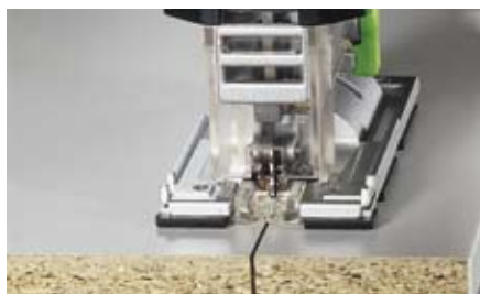
Рез без сколов материала при использовании противоскольного вкладыша.
