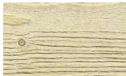
Структурировано с помощью щетки LD 85.
