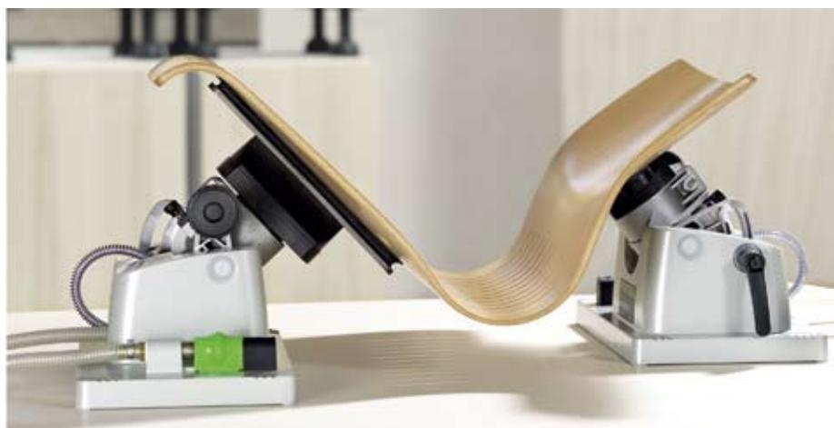
Зажим изогнутых заготовок не представляет проблем для вакуумной зажимной системы VAC SYS.
