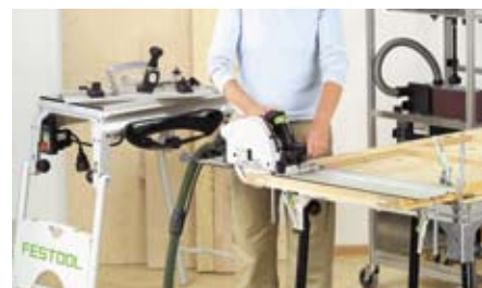
Установленные инструменты могут использоваться не только стационарно, но и вручную – для максимального удобства при выполнении работ.
