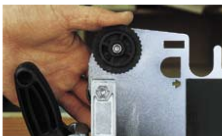
Надежно установить заготовку и шаблон по уже имеющимся настройкам поможет эксцентриковая шайба с памятью и простая система зажима.
