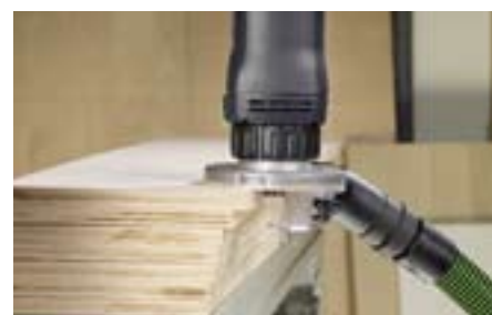
Фрезерование пластмассовой или деревянной кромки.
