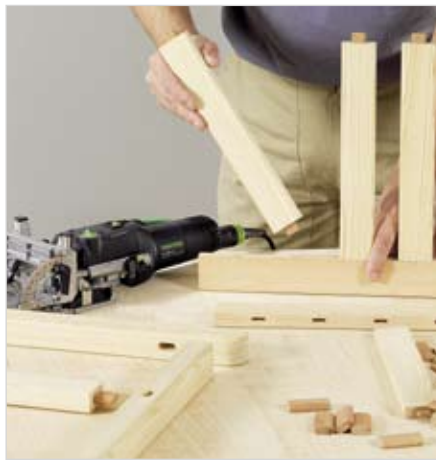
Соединение узких планок шириной от 25 мм
