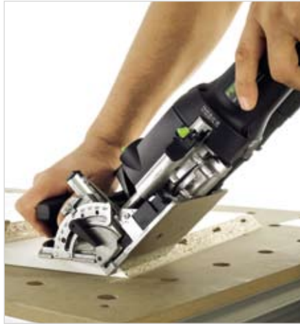
Точное соединение на «ус»
