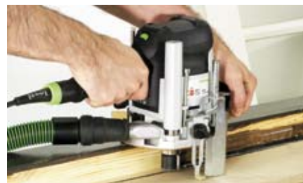
Остатки клея и уплотнителя могут быть удалены почти полностью перед установкой изолирующих стекол.
