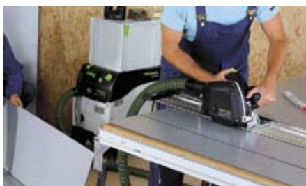
Эффективное пылеудаление обеспечивает 36 мм-шланг и пылеудаляющий аппарат Festool.
