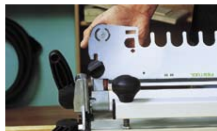
Для последовательного фрезерования нескольких заготовок достаточно просто откинуть шаблон вверх. Его не нужно снимать.
