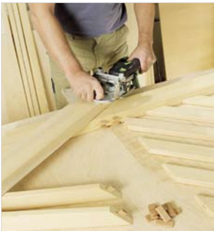
Прочное соединение рамных конструкций вне помещений
