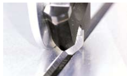
С помощью контактного ролика надежно устанавливается точная глубина фрезерования. Фреза погружается в материал ровно настолько, насколько это позволяет контактный ролик.
