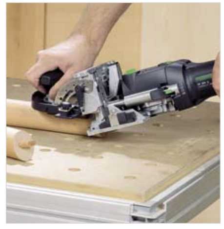
Соединение круглых стержней с помощью круглого упора
