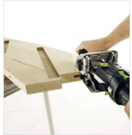
Соединение панелей из массива древесины, например, тетивы лестницы
