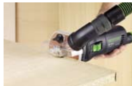
Фрезерование пластмассовой или деревянной кромки заподлицо.
