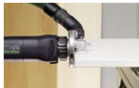
Скругление пластмассовой или деревянной кромки.
